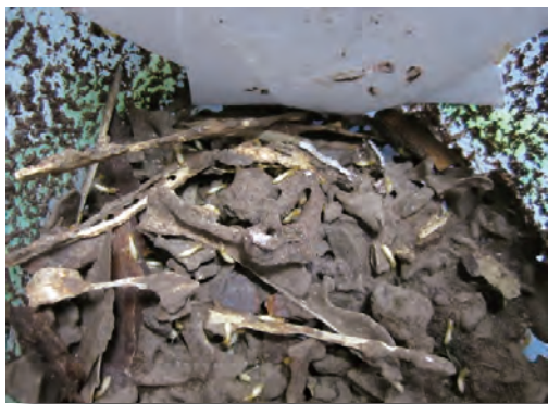
シロアリへの抵抗性の確認実験
