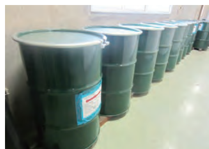
PCB 廃棄物保管状況
